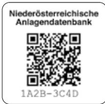
Das Anlagenetikett (I.) mit eindeutiger Anlagennummer und QR-Code ermöglicht es, Messwerte direkt über eine digitale Schnittstelle in die Anlagendatenbank einzutragen.
