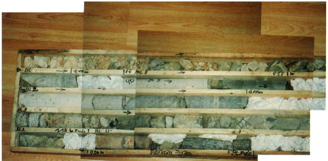
*Die Bohrkern, die der Stütze entnommen wurden und auf denen der schlechte Zustand des Steines bereits erkennbar ist.*
