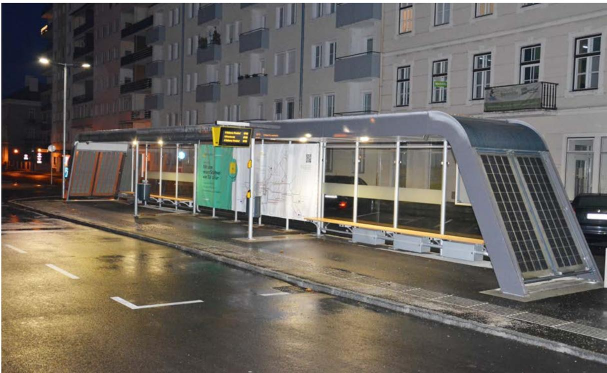
Moderne Haltestellen können mittels Photovoltaikpaneelen eine Energieversorgung auch bei entlegenen Haltestellen sicherstellen.
