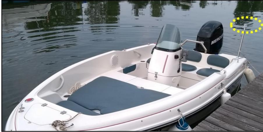
Für Fahrzeuge unter 7m Länge (laut Zulassungsurkunde) reicht als Navigationsbeleuchtung ein einfaches weißes Rundumlicht aus.
