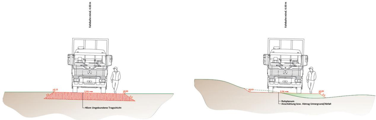
Abbildung: Regelquerschnitte unbefestigte Fahrwege (Quelle: Einreichunterlagen, Einlage 3078)
