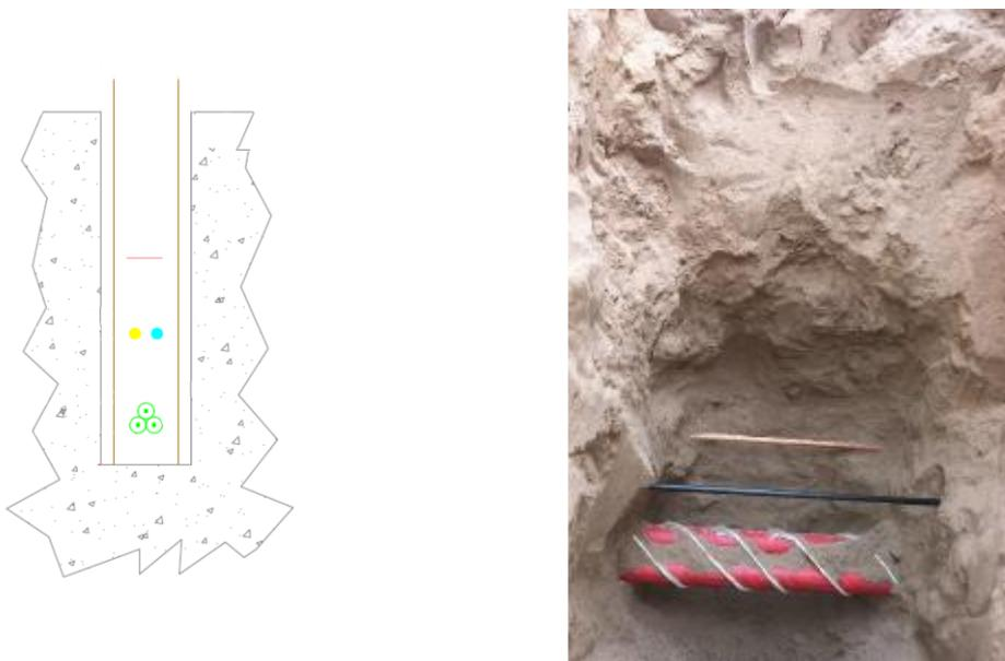
Abbildung 4-7: Beispielansicht für einen optimierten Grabenaushub und die reale Kabelposition <sup>10</sup>
