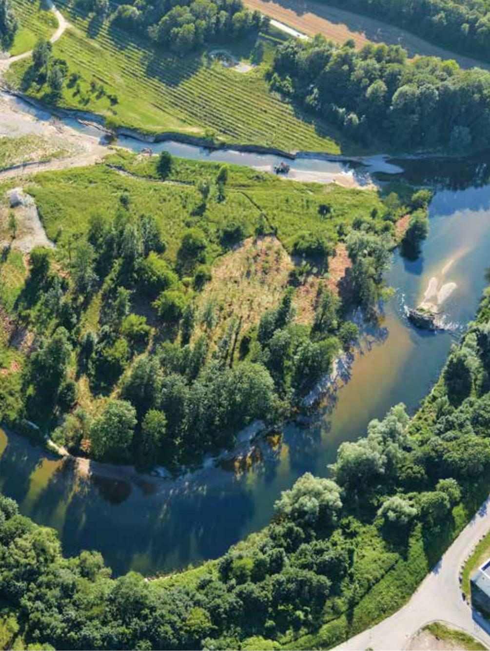
sicherungen wurden rückgebaut und das Flussbett mit strömungslenkenden Maßnahmen wie Buhnen und Raubäulen strukturiert. Dadurch entstand ein naturnahes Flussbett mit pendelnder Linienführung und gewässertypischer Strukturvielfalt, das Lebensraum für viele Tiere und Pflanzen bietet.
