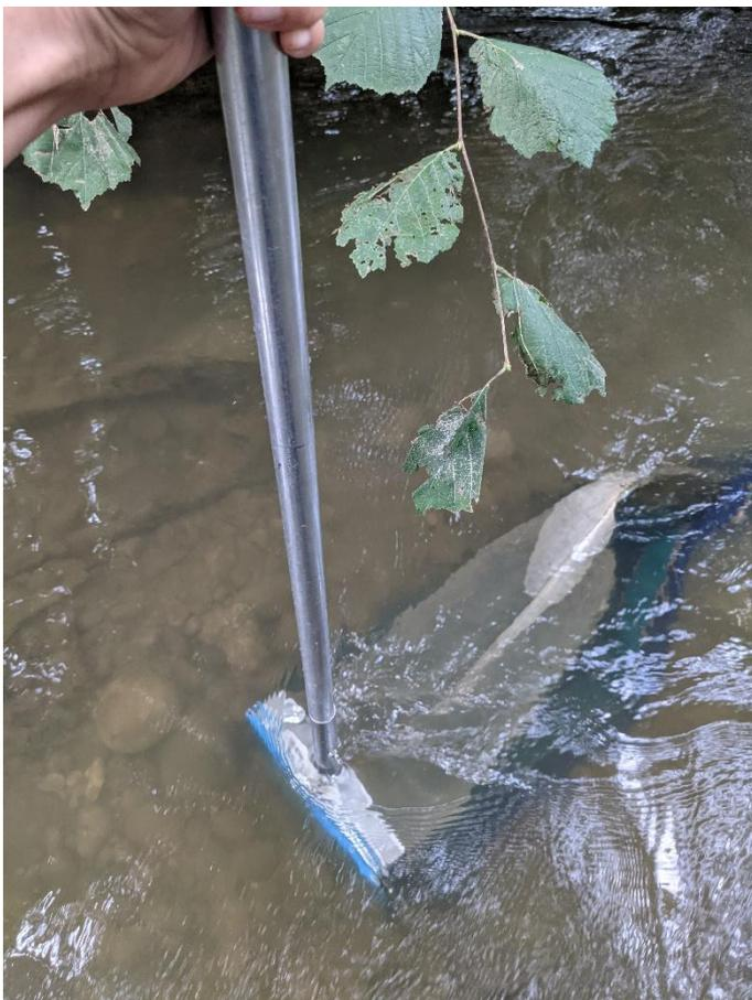
Abb. 79 Handnetz mit 500 µm Maschenweite und 120 cm Netzsacklänge.
