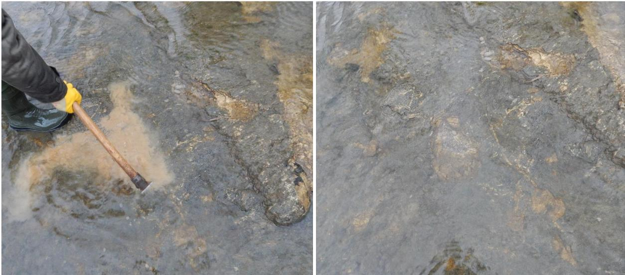
Abb. 17 Versinterung der Gewässersohle des Erlabaches in St. Pantaleon.
