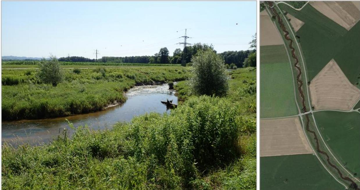
Abb. 73 Links: Morphologische Aufwertungsmaßnahme im Unterlauf der Naarn. Rechts: Der Fluss wurde nach Entfernung der Ufersicherung innerhalb der bestehenden Dämme in einen pendelnden Lauf gelegt (aus (Graf & Gumpinger, 2020)).
