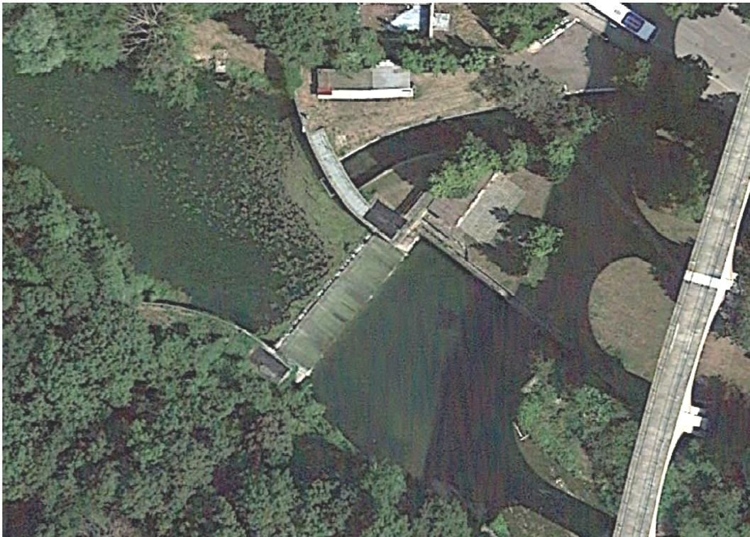
Abbildung 4. Helenenwehr zur Ausleitung des Badener Mühlbaches. Rechts: Querung der Wiener Hochquellwasserleitung.
