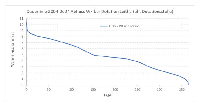
Abb. 4.7: Dauerlinie Warme Fischa unterhalb Dotationsstelle Messreihe 2004 – 2024
