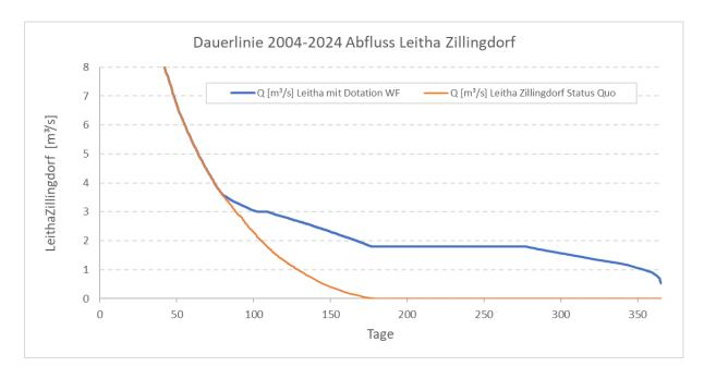
Abb. 4.4: Dauerlinie bei Dotationsstelle Zillingdorf mit Dotation aus warmer Fischa und Status-Quo (Messreihe 2004bis 2024)
