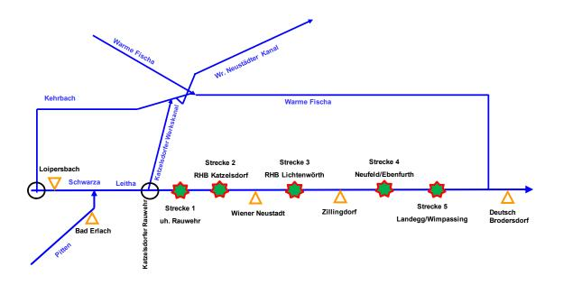
Abb. 3.1: Fließschema und Lage der Messstellen Dotationsmessung Leitha
