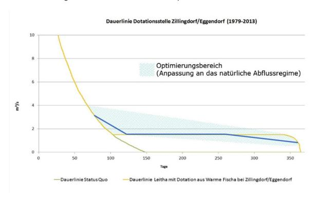
Abb. 4.3: Dauerlinie an der Dotationsstelle bei Zillingdorf (Messreihe 1979-2013), blau: schematischer Vorschlag für eine an das natürliche Abflussregime angepasste Dotation
