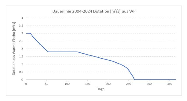
Abb. 4.5: Dauerlinie benötigte Dotation Warme Fischa Messreihe 2004 – 2024
