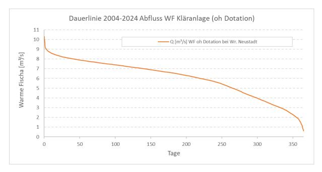
Abb. 4.6: Dauerlinie Warme Fischa oh Dotationsstelle Messreihe 2004 – 2024
