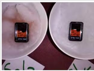
Die Temperatur in der Schüssel mit dem Salzsnee sinkt stark ab (bis  $-16^{\circ}\text{C}$ ).
