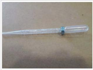
Schiebe die Mutter entlang des Pipettenhalses bis unter den Druckraum.
