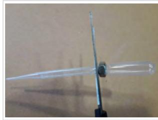
Schneide direkt unterhalb der Mutter die Pipette ab.
