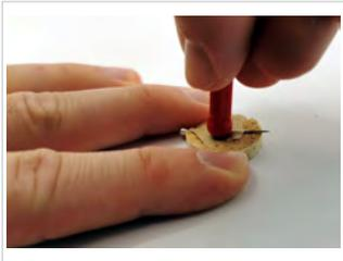
Streiche mit dem Nordpol des Magneten 30 mal vom Kopf zur Spitze der Nadel.
