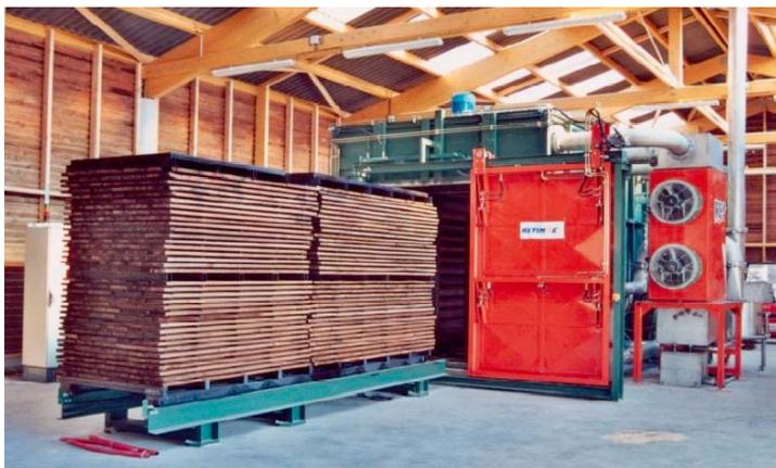
**Abb 8 - Produktionsanlage von Retified Wood®
