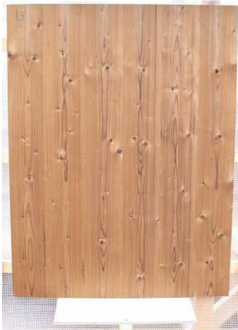
**Abbildung 8f - Fassadenelement 6: stehende Profilbretterschalung**
