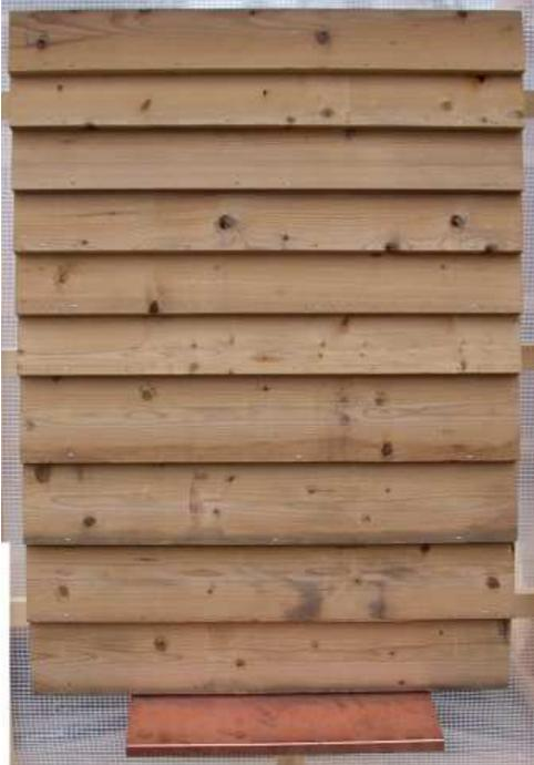
**Abbildung 8c - Fassadenelement 3: Stülpschalung**
