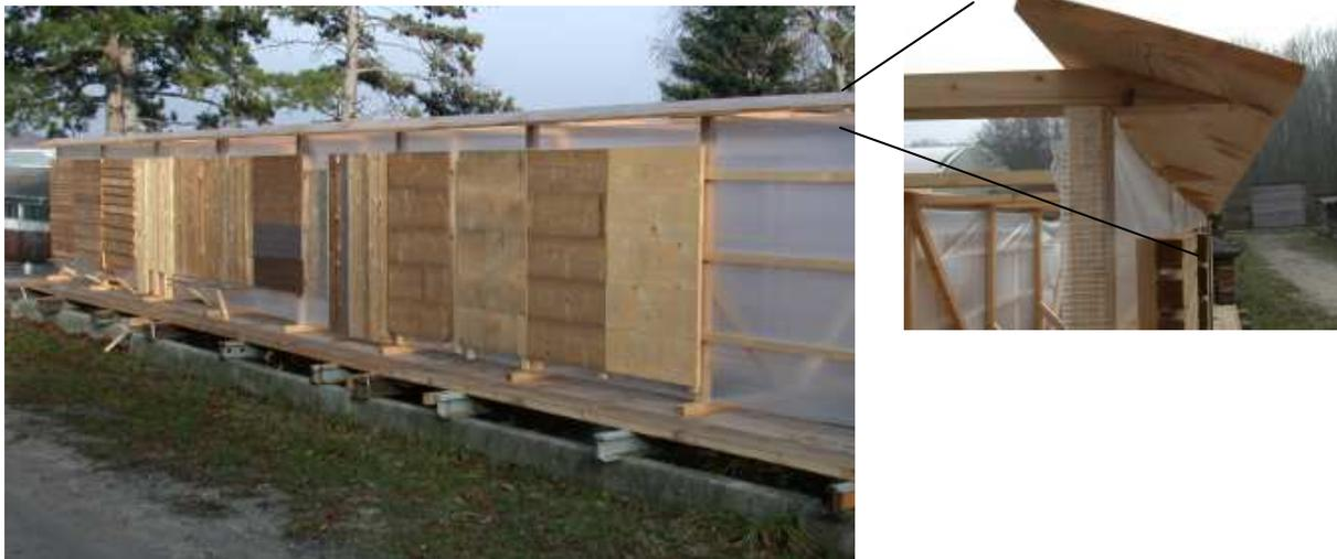
Abbildung 7 – Fassadenstand bei Beginn der Bewitterung im November 2006
