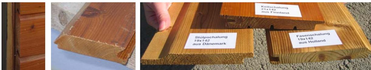
Abbildung: Profilierte Bretter aus Fichten-Thermoholz. Fotos: Manuel Schweizer
