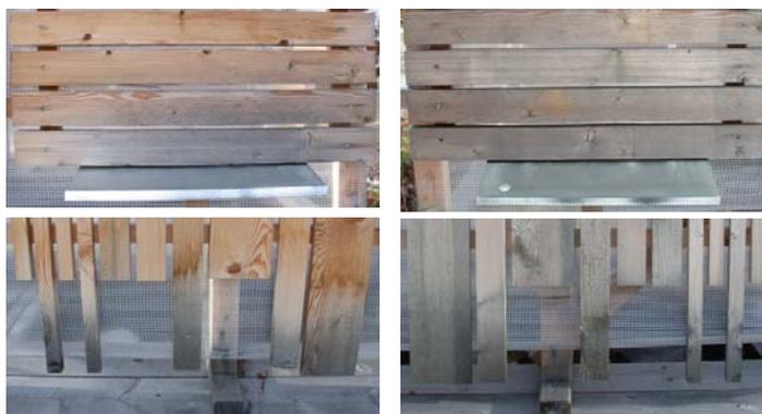
Der geringe Dachüberstand (Abb 68) von ca. 20 cm hatte bereits Auswirkung auf die Farbentwicklung auf den Fassadenelementen. Es kam im beschatteten Bereich (Abb 129) zu einer geringeren Abnahme der Farbintensität und die Helligkeit ist weniger angestiegen (Abb 100). Die Traufe zeichnete sich also eindeutig ab.
