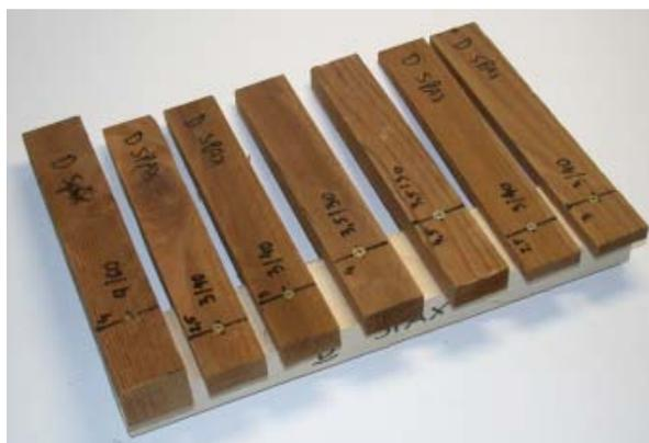
Abb 143 - Beispiel der Probenvariante D mit dem SPAX-S als Befestigungsmittel
