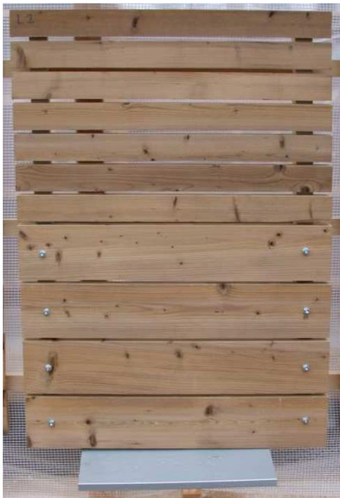
Abbildung 8b - Fassadenelement 2: liegende Schalung
