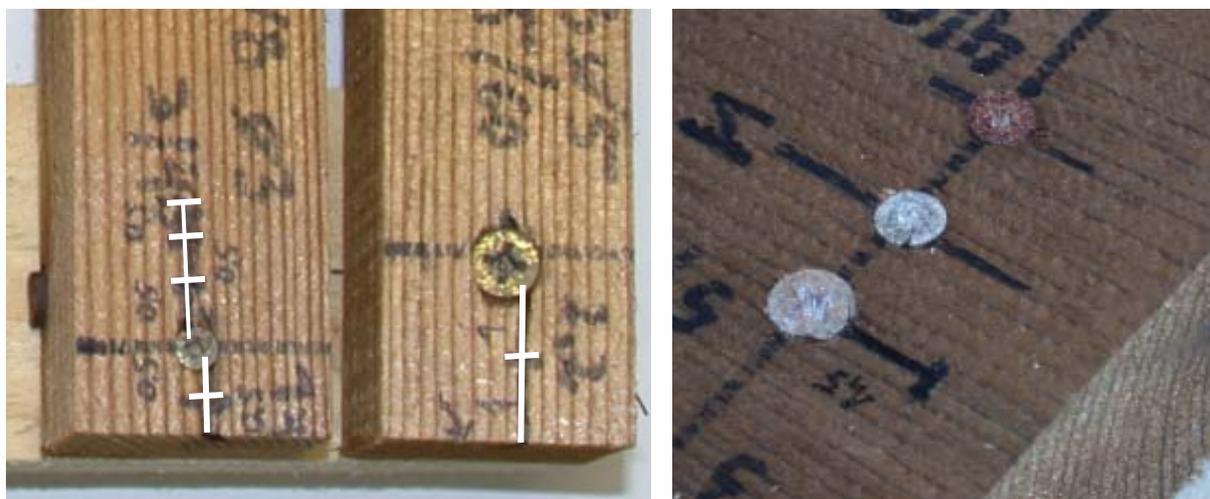
Abb 148, 149 & 150 - Befestigungsmittel: SPAX-S (mit und ohne Vorbohrung); schrittweise Rissbildung bis an die Stirnfläche (links oben) und Korrosion der SPAX- (rechts oben); Probenmaterial mit unterschiedliche Randabständen und drei Rissbildungen (links)
