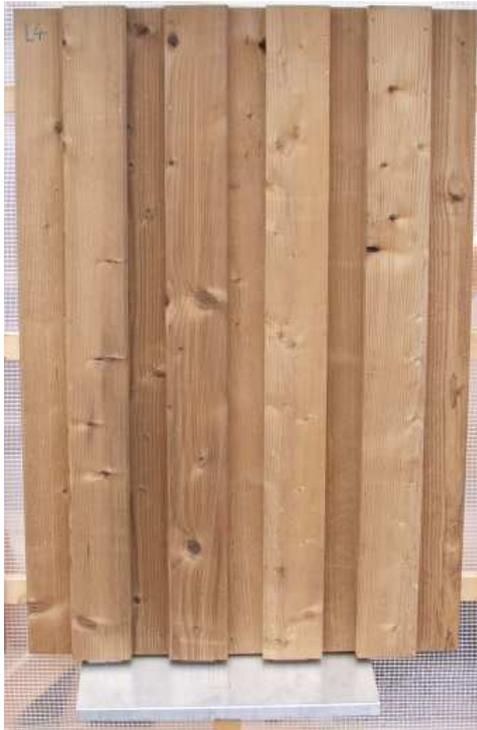
**Abbildung 8e - Fassadenelement 5: stehende Brettschalung**
