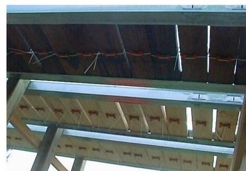
Abbildung 15 & 16 - Verwitterung der Proben nach einem Jahr
