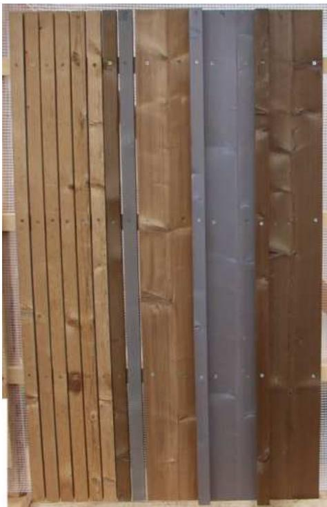
**Abbildung 8h - Fassadenelement 8: stehende Lattenschallung bzw. Decklattenschallung**
