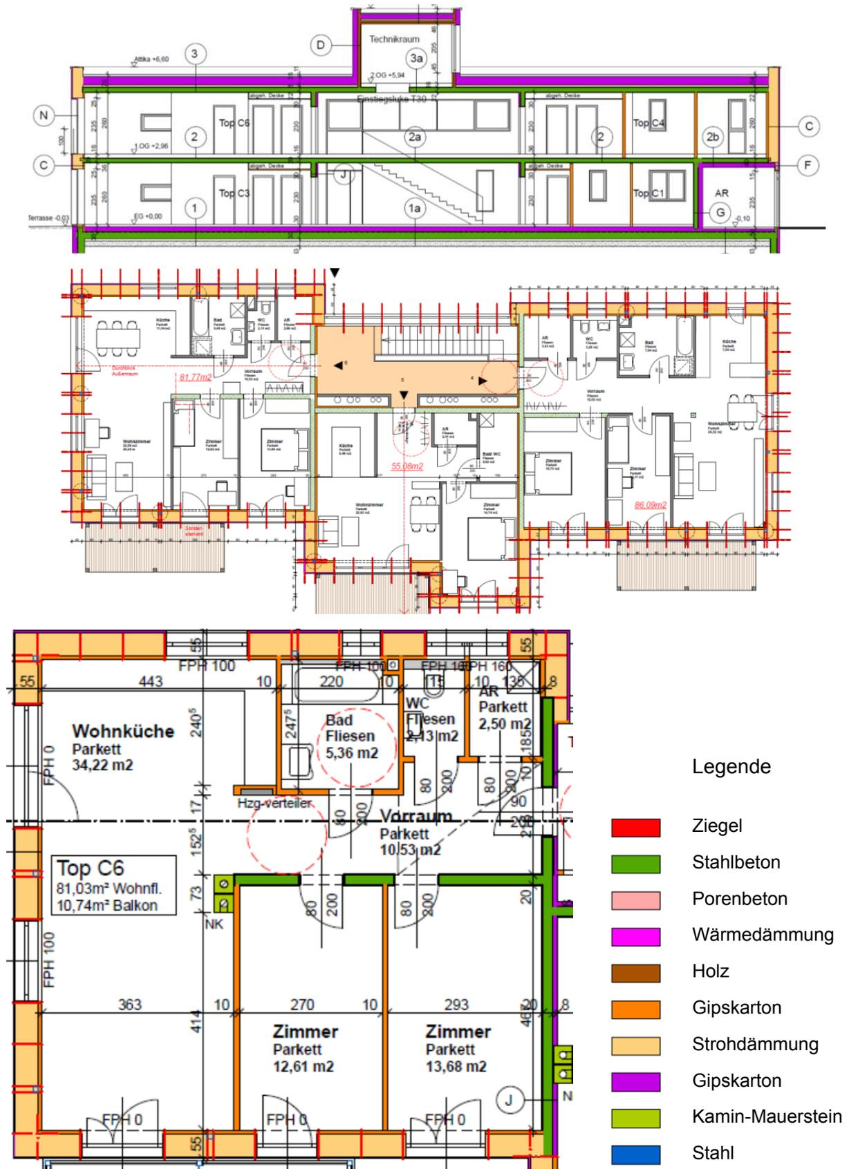
Abbildung 63: Einreichpläne Block C – Stroh-Holzbauweise. Längsschnitt, Grundriss 1. OG, gesamt + Top C6, 25.02. und 29.03.2011 (Treberspurg & Partner Arch., 2011)
